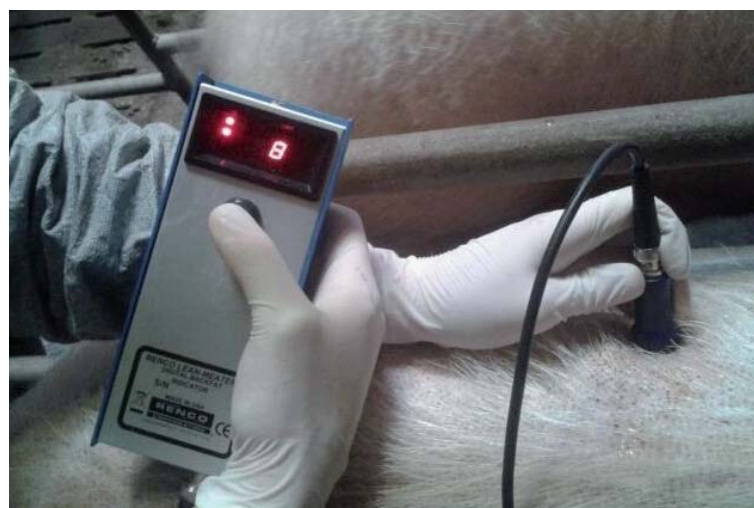
Par exemple sur le Renco®, le nombre de couches mesurées correspond au nombre de diodes affichées à gauche de la valeur.
