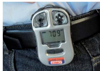
Figure 3 : Exemple de détecteur portatif de CO. L'éleveur est averti en temps réel (source : Chêne Vert Conseil)
